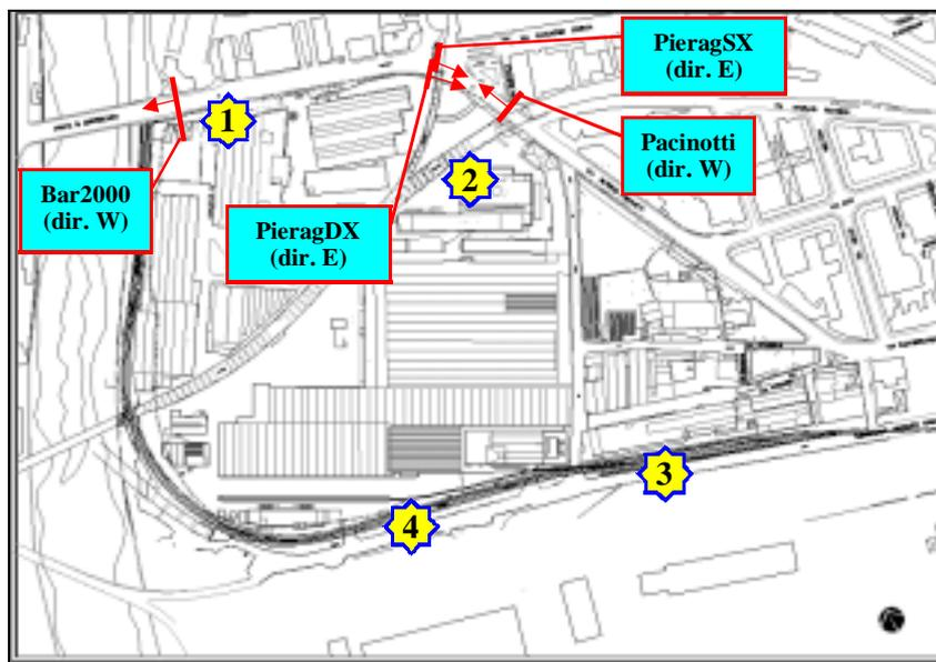
Il punto 1 è relativo al rilievo su 24 ore del rumore del traffico stradale su via Pieragostini; è stata impiegata una risoluzione temporale di 15 minuti per il livello equivalente ponderato A conformemente alla frequenza di rilievo dei dati di traffico.
