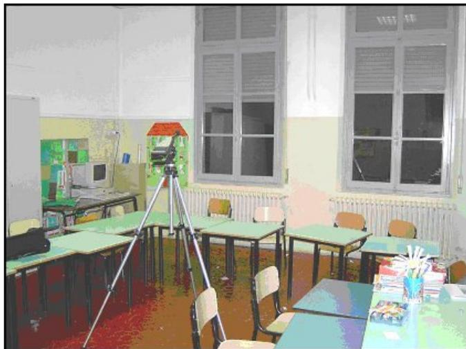
Fig. 2 – Posizionamento del fonometro per la misura interna.
